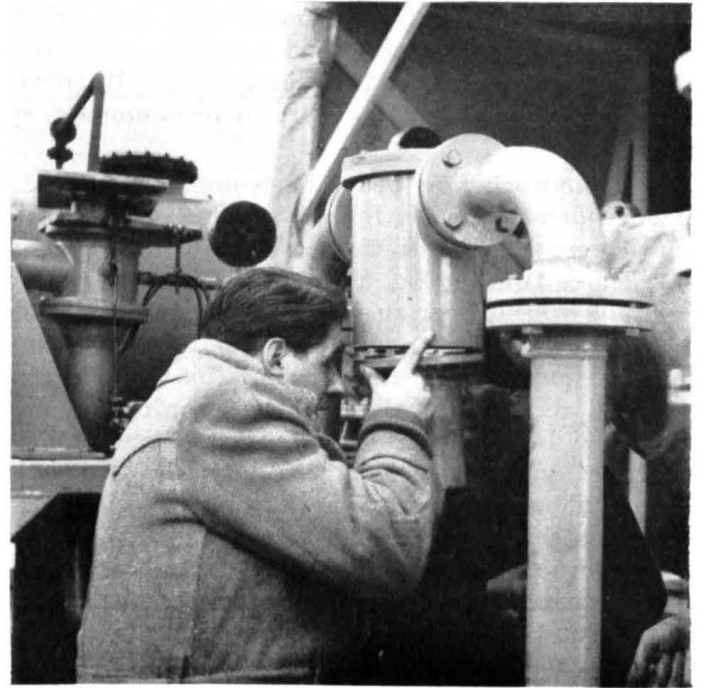
Bild 2 Der schallerzeugende Teil der Sirene.
